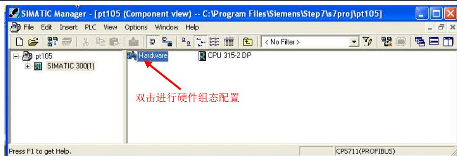
图 7.4 选择 PLC 主站，新建工程
