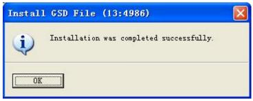
点击 OK 按钮,关闭导入 GSD 文件窗口。刚刚安装的待测设备将会出现在硬件组态界面的右侧树形列表中,如下图所示:
