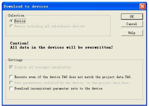
点击 OK 按钮,下载配置,下载结束后点击 close 按钮关闭窗口。给控制器断电。
